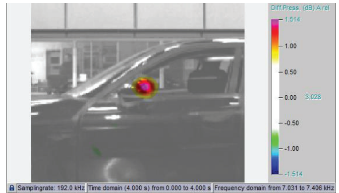
Abbildung 12: Differenzkarte der A-Säule, Frequenzbereich 7,0 - 7,4 kHz
